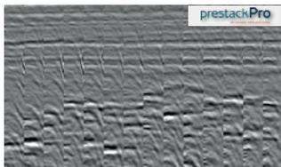
*Seismische Gather nach Prestack Tiefenmigration. Gekrümmte Einsätze (oberes Bild) stammen von multiplen Reflexionen und werden von der ML-Software als solche erkannt und eliminiert (unteres Bild).*
