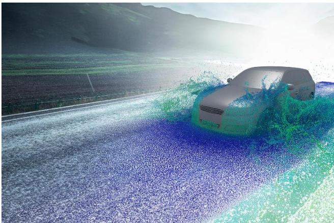
**Abb. 2** Die verwendete numerische Punktwolke ist dazu in der Lage, sich flexibel an bewegliche Geometrien anzupassen. So können komplexe Abläufe wie z. B. Wasserdurchfahrten zeitsparend simuliert werden.
